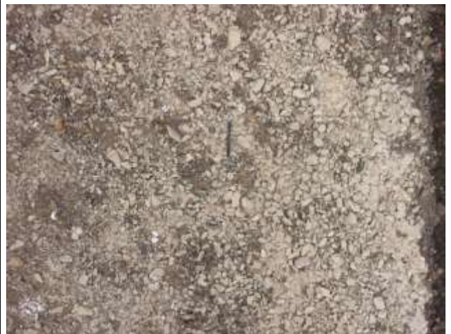
Granulométrie de l'armure (couche de surface)
