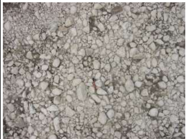
Granulométrie de l'armure (couche de surface)
