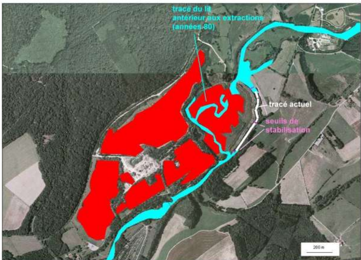
Figure 19 : extractions en « lit majeur » dans le secteur de Pont sur l'Ognon. En bleu le tracé antérieur aux exploitations. En violets les trois seuils de stabilisation du fond du lit.
